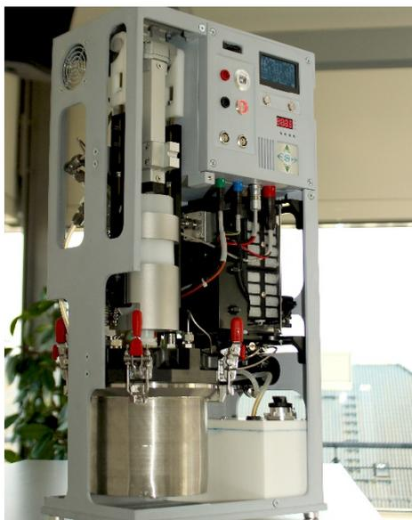
**Abb. 2 TRL5-Demonstrator eines Stromgenerators mit eingelegter POWERPASTE-Kartusche und 100 W-PEM-Brennstoffzelle.**
